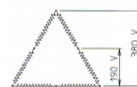
Verlaagd ontdooivermogen (elementen in de aansluitkast ompolen).
